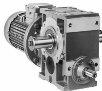
Motorreductor de ejes ortogonales ICI (también CI) con árbol lento de doble salida y salida de árbol rápido (ejec. UO3D).
