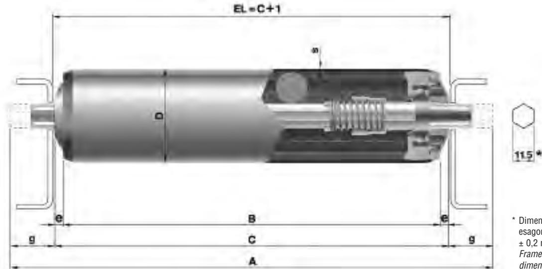
\* Dimensione del foro esagonale nella struttura  $\pm 0,2$  mm.
