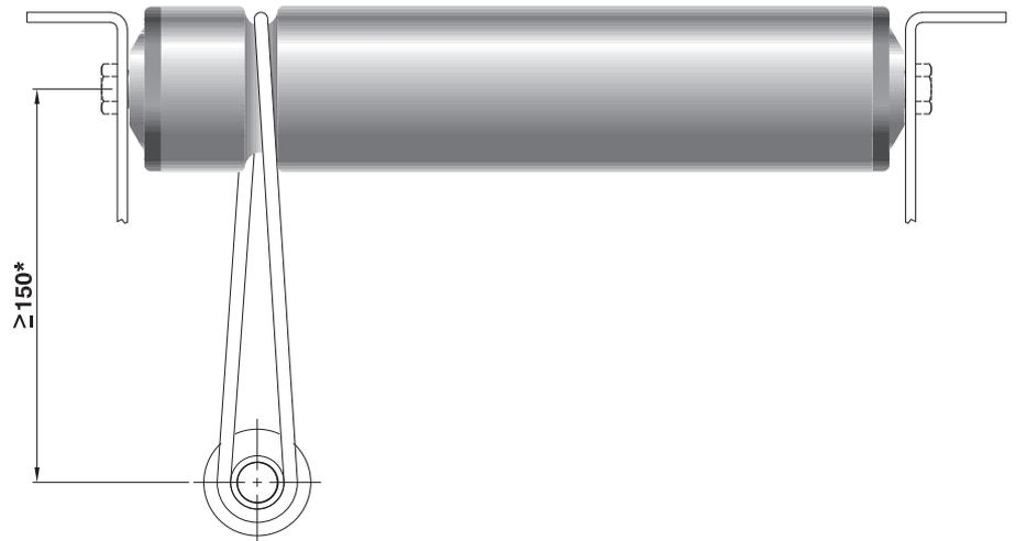
(\*) da determinare consultando i fornitori delle cinghie, in rapporto alle caratteristiche delle stesse ed ai diametri di avvolgimento.
