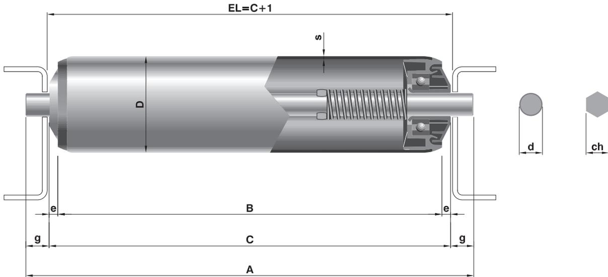
**Tubo in acciaio / With steel tube**
