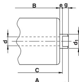
**B** asse con chiave (ch) ottenuta con bussola metallica
