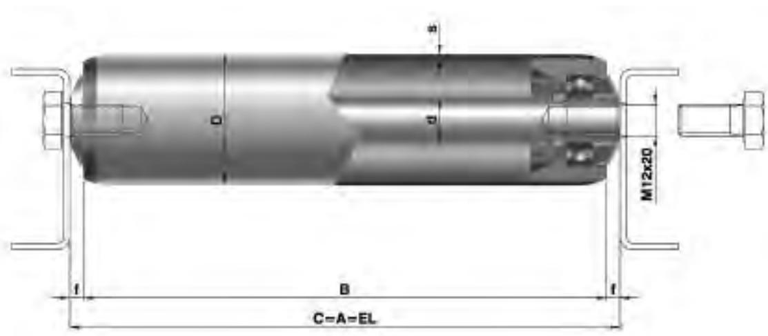
**Tipo 117/75 con asse d=17 / 117/75 type with shaft d=17**
