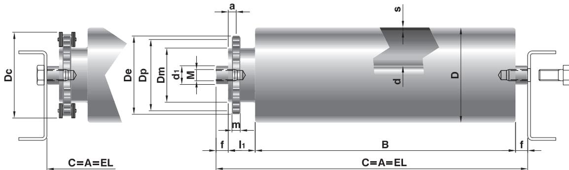
Rulli con pignone P1C per catena tangenziale semplice / Pinion sprocket rollers P1C for simple tangential chain
