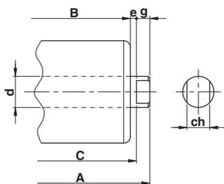
**F** asse con chiave (ch) ottenuta con fresatura
